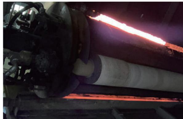
保温・築炉(断熱材を施工した連続鑄造炉)
