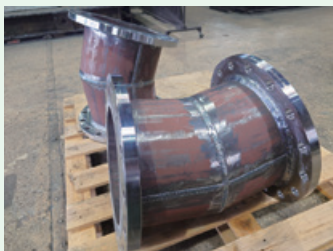
粉体圧送エルボ配管
