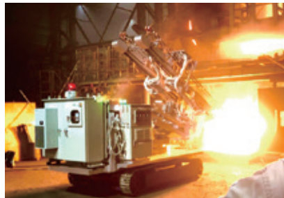
溶鋼温度を測定する無線ロボット（山口事業所）
