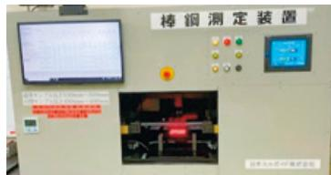
製品の形状や重量などを自動で測定する機械を導入しています。
