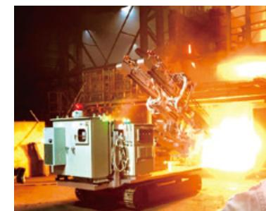
溶鋼温度を測定する無線ロボット(山口事業所)
