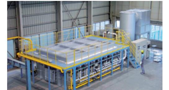
防耐火試験装置 (水平炉)
