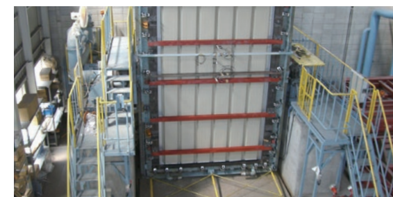
水密・耐風圧試験装置(大阪工場)
