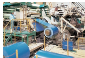
カラー鋼板製造設備
