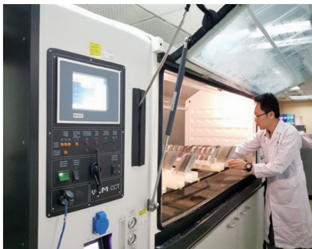
複合循環腐食試験機 (CCT)
