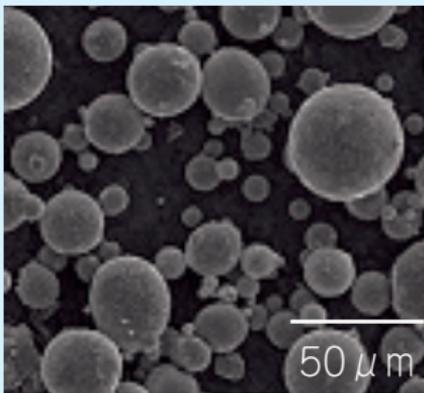
開発した導電フィラー用金属粉末の拡大写真
