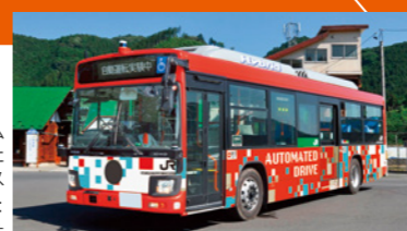
自動運転支援システム「GMPS」が採用されたBRT専用大型自動運転バス 画像提供：東日本旅客鉄道株式会社
