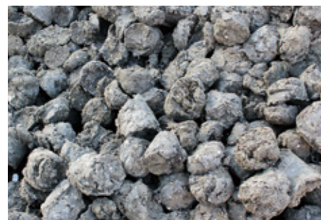
ドライ固化物 自動車工場鉄スクラップ(切粉)とASR(ASRの再選別処理物)を混合し成型した溶融固化物
