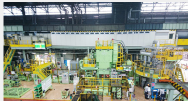
グローバル標準ライン<材料加熱→鍛造成形→鍛造恒温焼きならし一貫ライン>
