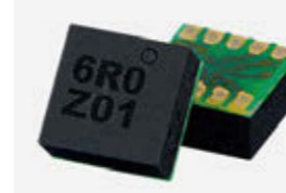
「GMPS」に使用される超高感度磁気センサ「MIセンサ」
