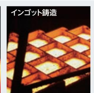
溶湯を鑄型に流し込んで20kgのインゴットに仕上げます。
