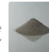
水素吸蔵合金は、水素を吸蔵したり放出したりできるユニークな合金で、ハイブリッド車用ニッケル水素電池の負極材料として使用されています。
