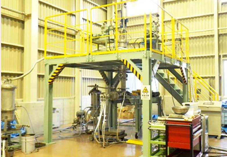
薄膜蒸発機+異速型SCプロセッサの脱溶剤システム
