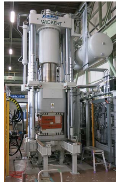
470ton 樹脂成形用油圧プレス機
