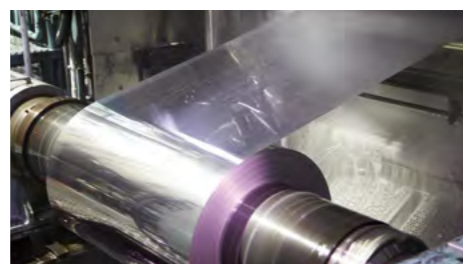
■三菱アルミニウム社の箔圧延工程
