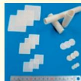
一般市販品の5倍以上という高いイオン伝導率を有するリチウムランタンチタン酸化物（LLTO）を開発しました。車載用や電力貯蔵用蓄電池として期待される次世代のリチウムイオン電池の固体電解質として有望な素材です。
