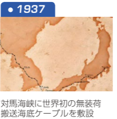
● 1937 対馬海峡に世界初の無装荷搬送海底ケーブルを敷設
