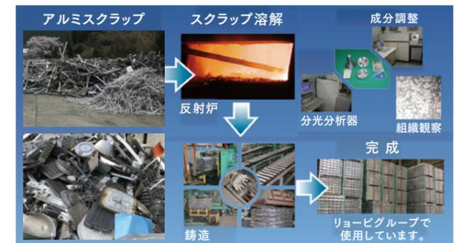
アルミニウム合金は、アルミ缶、自動車のナンバープレートやホイール、アルミサッシ、銅など、さまざまなアルミスクラップからリサイクルされます。生野株式会社（兵庫県朝来市）では、アルミニウム合金を製造しています。製造された二次合金は、国内グループ各工場 で高品質なダイカスト製品に生まれ変わっています。
