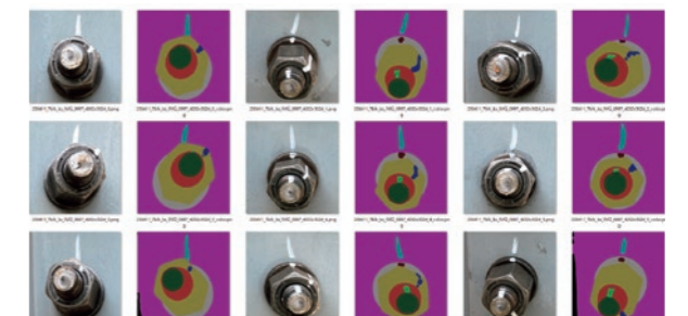
画像認識AIによる、ボルト認識の例
