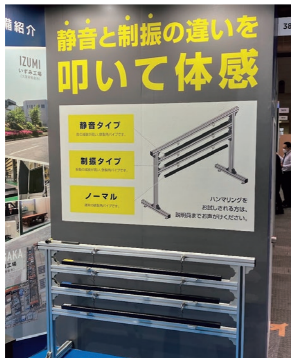
静音にも対応した新たな高減衰構造フレーム (展示会デモ機)
