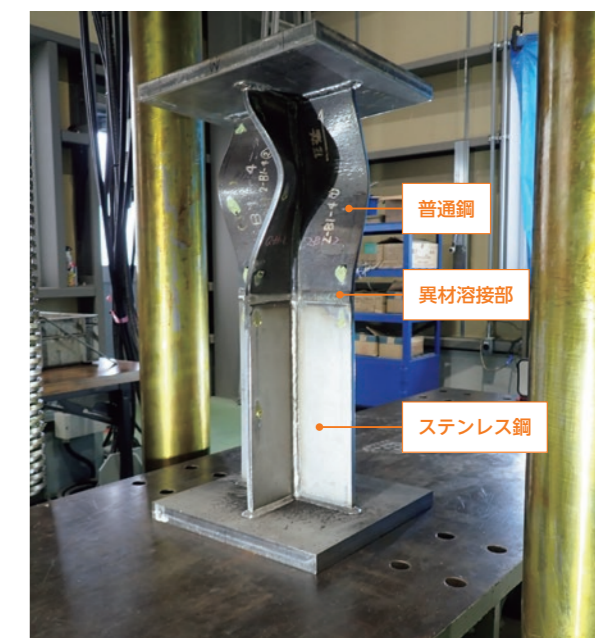
普通鋼とステンレス鋼のハイブリッド構造の実験
