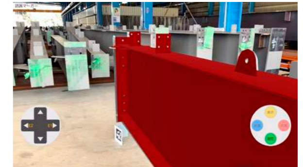
〈柱梁の組み立て検査システム〉 AR(拡張現実)技術を用いて実際の部材に3Dモデルを重ねて表示し、小物の取り付け位置の確認等の検査業務を支援します。
