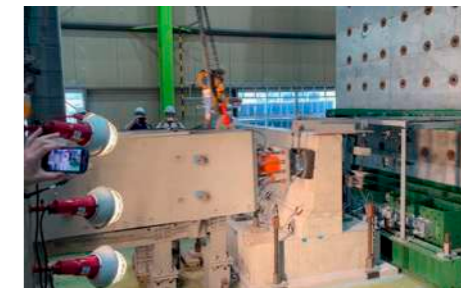
ラピッドガードフェンスの衝突実験
