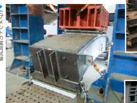
セグメントの載荷試験
