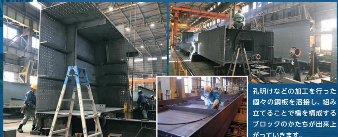
孔明けなどの加工を行った個々の鋼板を溶接し、組み立てることで橋を構成するブロックのかたちが出来上がっていきます。
