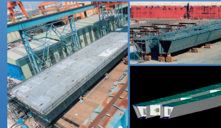
組立が完了した個々のブロックを橋の完成形または部分的に組み立てることで形状や寸法に間違いがないかを検査して、現地での施工に不具合がないように確認を行います。仮組立には実際にブロックを組み立てる「実仮組立」とコンピュータによる3次元計測システムを用いた「シミュレーション仮組立」があります。
