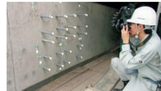
アンカーボルト位置の3次元計測の例「アンカー版VFORM」
