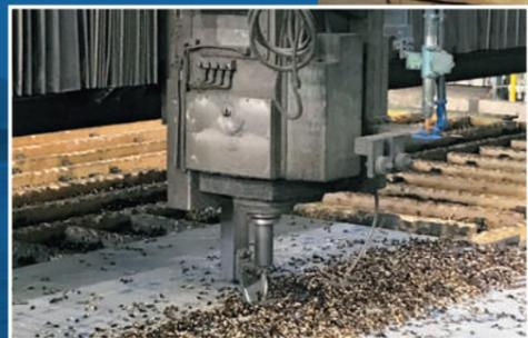
調達した鋼板を設計した形状に切断します。鉄の橋は工場から現場へ運ぶことが可能な大きさのブロックに分割して製作します。また橋を構成するブロックどうしを接合する方法としてボルトを用いるのが一般的です。そのために切断した鋼板の接合箇所にもボルト孔を明けます。
