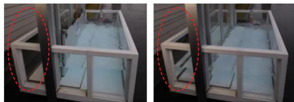
ラクセットを設置した場合(写真左)は、屋内側にほぼ浸水しない。一方、設置していない場合(写真右)は、屋内側に浸水していく。
