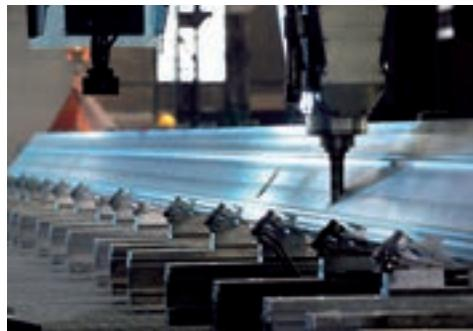
STEP-G 大型形材加工工程
