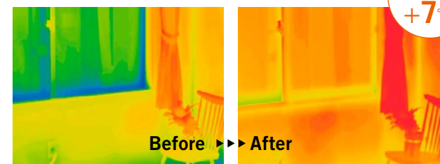
今ある窓のみ(単板ガラス3mm) / 今ある窓+内窓(インプラス)/単板ガラス3mm+Low-E復層ガラス 5℃ 30℃ (サーモグラフィー撮影条件: 室外温度0℃、室内温度20℃)
