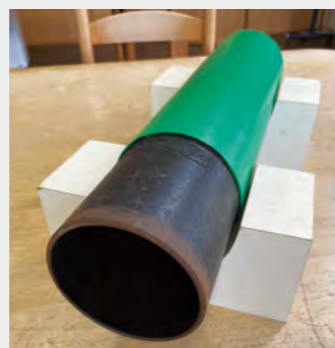
埋設されている水素パイプライン
