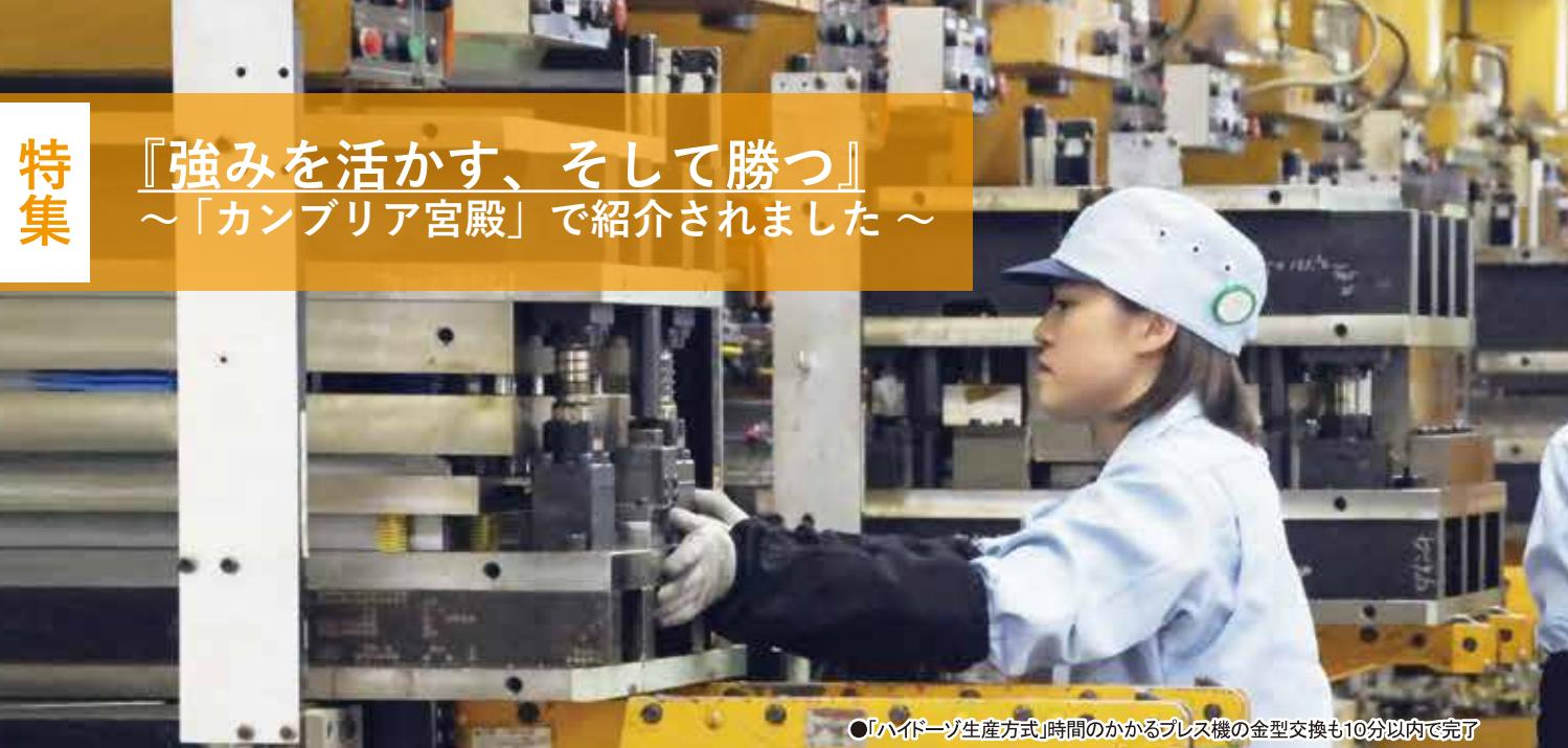
●「ハイドーゾ生産方式」時間のかかるプレス機の金型交換も10分以内で完了
