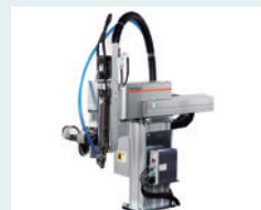
位置補正カメラ搭載ねじ締めロボット SR580Yθ-Z-VR
