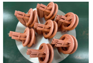
金属3Dプリンターによる純銅製誘導加熱コイルの一例
