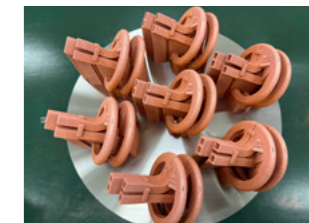
金属3Dプリンターによる純銅製誘導加熱コイルの一例
