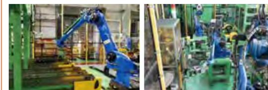
ロボットによる自動搬送や通電式焼熱処理により省人・省エネを実現
