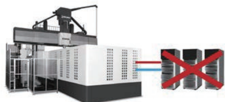
精度維持のための特別な冷却装置なしでも抜群の寸法安定性 ※ 門形マシニングセンタ実績 室温8℃変化
