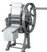
1898年 手動式麵線製造機
