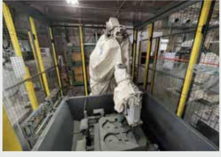
**砂型へのロボットによる直接加工と自動化**
