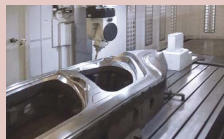
MCR-Sによるプレス金型の加工(乗用車のボディ)
