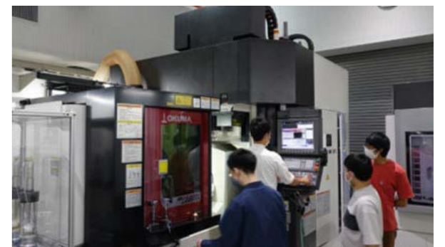
オークマ工作機械工学館での実験(機械は積層造形も可能な当社製5軸制御立形マシニングセンタ MU-6300V LASER EX)
