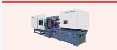
加熱溶融させたプラスチック素材を金型と呼ばれる金属製の型に射出注入し、冷やし固めて素材を成形する機械装置。
