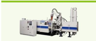
溶融させた金属(アルミニウム・マグネシウム)に高い圧力に加え、金型に注入することで製品を鋳造する機械装置。
