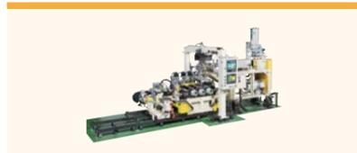
加熱溶融させたプラスチック素材を押出口から押し出し、空気や水の中で冷却して成形する。押出口の形状に従い、シート状やホース状に成形する機械装置。
