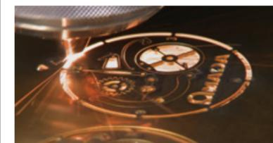
ファイバーレーザーマシンによる銅(高反射材)の加工
