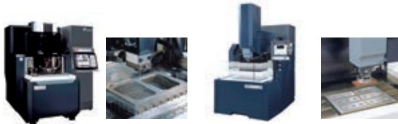
ワイヤ放電加工機は主に自動車、IT製品、電気製品、半導体などの精密プレス金型の加工や医療機器などの精密部品加工に使われています。
