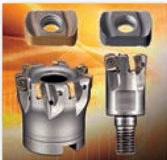
チップ両面4コーナ仕様の高効率荒加工用工具。チップ厚みを4mmと厚くし、断面強度を従来品比20%UP、また、刃先形状を最適化し、幅広い切削条件下で安定加工が可能。3次元ブレーカを採用したチップにより、切削抵抗は従来品とほぼ同等ながらも両面4コーナと従来品比2倍のコーナ数で経済的。チップ材種は新PVDコーティング材種〈JC8118P〉と〈JC7560P〉を採用、炭素鋼からプリハードン鋼、焼入れ鋼、高強度ステンレスなど幅広い被削材に対応しています。
