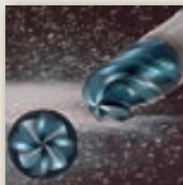
高い工具剛性と良好な切りくず排出性、不等分割・強ねじれ角の採用、高硬度材用新コーティング材種〈DH102〉の採用により、硬さ70HRCまでの高硬度材の荒から仕上げ加工に対応した4枚刃ソリッドボールエンドミル。
