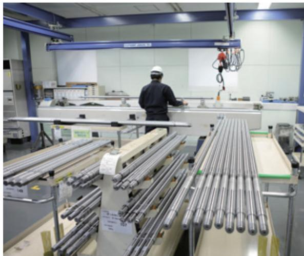
DMG MORIでは、品質向上と短納期化はもちろん、製品開発期間の短縮や安定供給などを目的に主要部品の内製化に取り組んでいます。ボールねじやATCをはじめ、部品加工から組立、検査までを一貫して行える主軸工場も重要な役割を果たしています。内製化は、日本、ドイツほか、世界各地で進めています。
