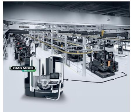
2020年9月、欧州最大の生産拠点であるフロンテン工場に新設した「monoBLOCKエクセレンスファクトリー」の稼働を開始しました。新設した広さ4,000㎡のmonoBLOCKエクセレンスファクトリーでは、無人搬送車によるライン生産を導入し、生産性が30%向上しました。これにより、年間生産能力は従来の600台から1,000台に拡大しました。
