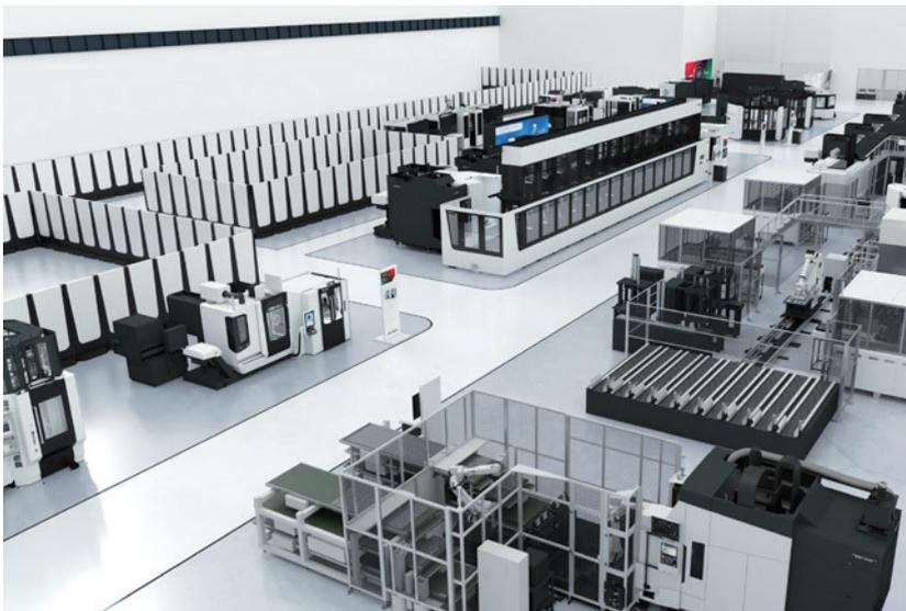
エンジニア、オペレータの不足が課題となる中、作業の一部をロボットなどに任せる生産工程の自動化が注目されています。自動化は、工作機械、搬送装置・計測機器などの周辺装置及び生産管理システムなどから構成されています。DMG MORIは、お客様の要望に合わせて、それらを組み合わせるターンキー専用のシステムソリューション工場を備え、お客様に最適なソリューションを提供します。デジタルツインシミュレーション内の『システムソリューションセンタ』では、16種類の自動化システムを完全再現しています。
