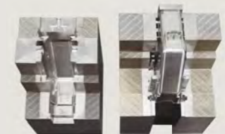
金属3Dプリンタを用いて製造した金型。内部には冷却配管が最適に設置されている
