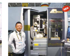
リアモータ駆動 高速高性能ワイヤ放電加工機 AL400G
