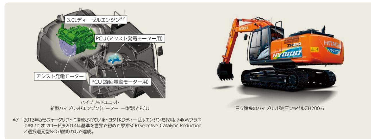
\*7: 2013年からフォークリフトに搭載されているトヨタ1KDディーゼルエンジンを採用。74kWクラスにおいてオフロード法2014年基準を世界で初めて尿素SCR(Selective Catalytic Reduction / 選択還元型NOx触媒)なしで達成。
