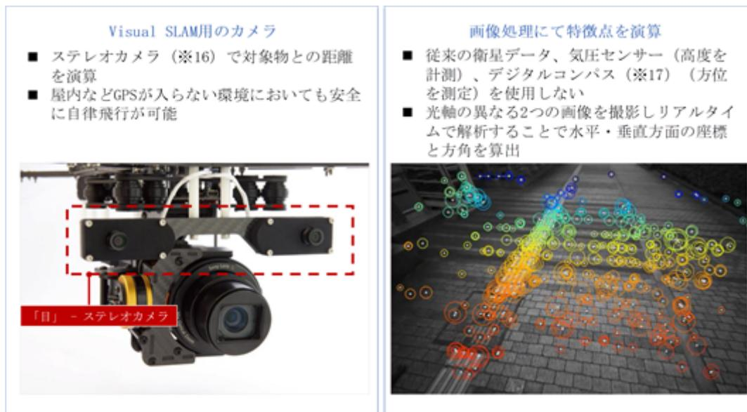
当社では、今後、本格化する目視外飛行や、通信が途絶えた場面、制御不能な状況を想定し、自律的ゴーホーム機能や各種緊急時の自動対応指示機能、操作・制御介入機能を搭載し、より安全で信頼性の高い制御を可能にする開発を進めております。FMEA(15)等の航空機技術で培われた知見を活用し、故障を論理的、系統的に分析することで、その対応を重要なものから順次、対策技術を導入していくことを試みております。
