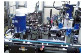
自動車部品のグリッパー搬送設備
