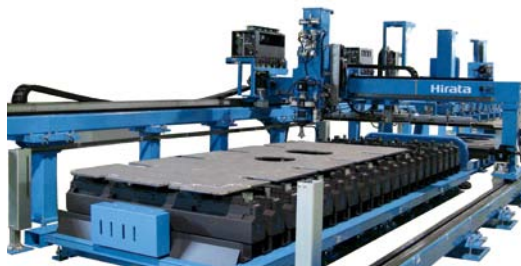
システム構成はR面取りロボット、移載ロボット、ポジショナー、オートツールチェンジャーなどの7つ。カスタマイズ可
