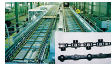
「MEPチェーン」コンベヤ 製品を作業者の前で停止する作業者視点のフリー フローシステムを採用
