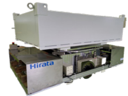
1tonタイプAGV(動作テスト機) - 昇降装置(100mm)、回転装置付(±90°) - パレットであれば1,400kgまで搬送可能
