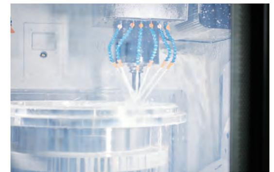
工具の全周から切削液をかけ、切削加工している様子
