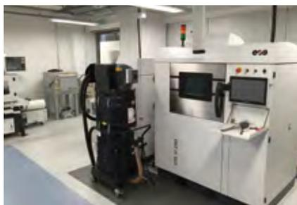
金属系3D プリンター(金属積層造形機)
