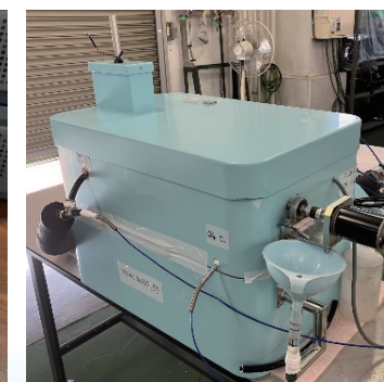
海水淡水化装置実験機
